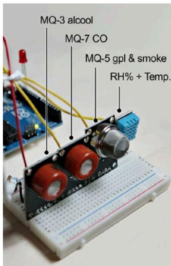
02 – Sistema di monitoraggio di dati ambientali urbani in real time. A sinistra, assemblaggio di una delle stazioni di monitoraggio; a destra, restituzione georeferita nel tempo dei dati monitorati da tre stazioni dislocate nella Città di Torino.
